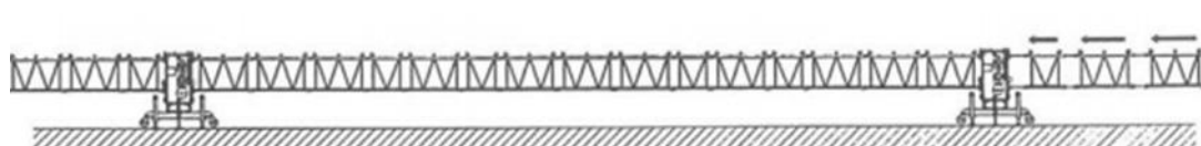
图 6.3.8-3 双柱型作业平台第三步安装示意图
