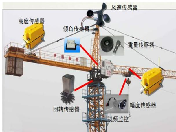
塔吊防碰撞系统由安装在施工塔机上的塔吊控制及显示器、安装在施工现场办公室的塔机控制器两部分组成。
